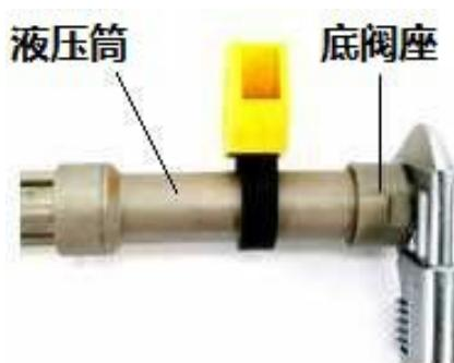
1. 用皮带扳手固定液压筒的同时，拆下底阀座。
