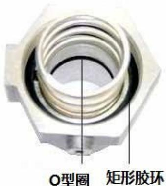
2. 将O形圈放在气缸座的槽内。将矩形胶环放在气缸座底座的顶部，圆柱弹簧在矩形胶环内部居中，并放在气缸座上。将导向套和气动活塞组件滑入气缸座。
