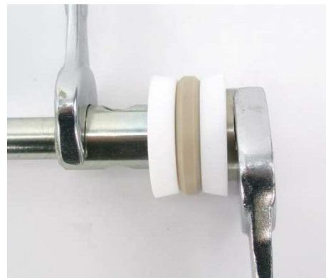
**动阀座拆卸。** 拆卸后，清洁并检查每个零件，如果有任何损坏，请在重新组装之前进行更换。重新安装时，请使用螺纹锁固剂。
