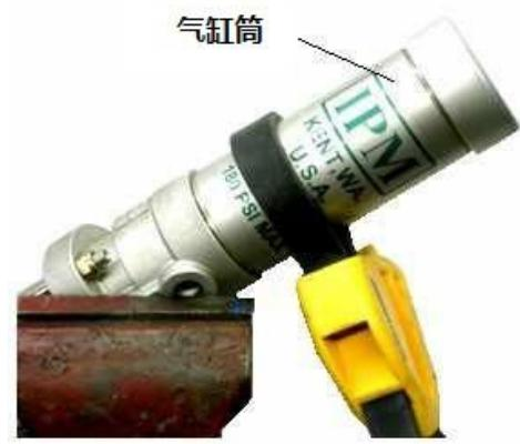
用手或用皮带扳手拆下气缸筒。
