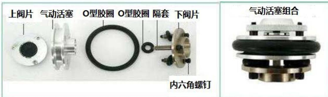
1. 加上平垫片将空气活塞组件（使用螺纹密封剂）组装到导向套上。只能用手拧紧。
