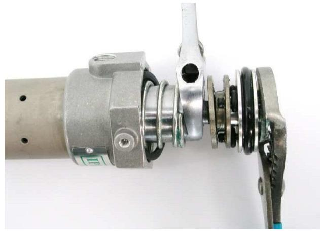
将一把大力自锁钳子放在上阀片滚花区域上，并将板扳手放在平面上以卸下空气活塞组件。检查气缸盖中的弹簧，以确保其没有损坏或松动。检查气缸盖中的垫圈，并根据需要进行更换。该垫圈将气缸盖密封到气缸筒上。还要检查下部复位圆柱弹簧，以确保将其正确固定到气动马达的气缸座组件中。
