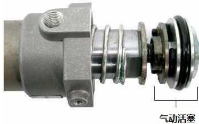
气缸筒和气缸盖已经从气马达上卸下。
