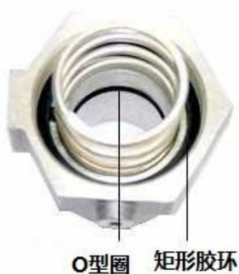
2. 将O形圈放在气缸座的槽内。将矩形胶环放在气缸座底座的顶部，圆柱弹簧在矩形胶环内部居中，并放在气缸座上。将导向套和气动活塞组件滑入气缸座。
