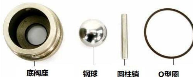
**底阀座零件。** 在IP02 短型泵上，底阀下方有3/4 英寸的内螺纹，而在长泵上则没有。如果您需要进一步伸入容器，建议安装延长管，以将底阀座保持在最低位置。
