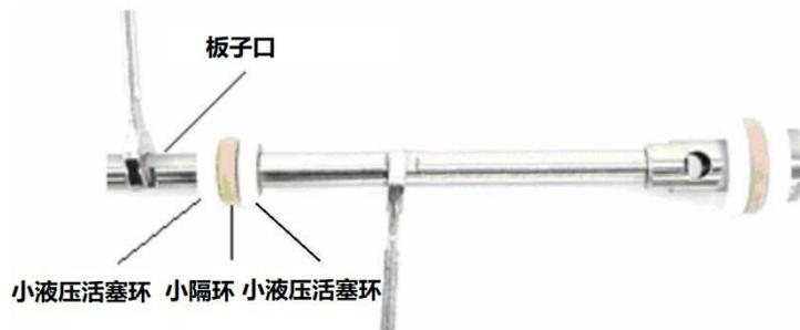
3. 用两把扳手拆下上液压活塞部分。注意聚大小液压活塞环的方向。一个朝上，然后在中间有一个耐磨隔环，第二个朝下，然后是一个压环。重新安装时，请使用所闻锁固剂。
