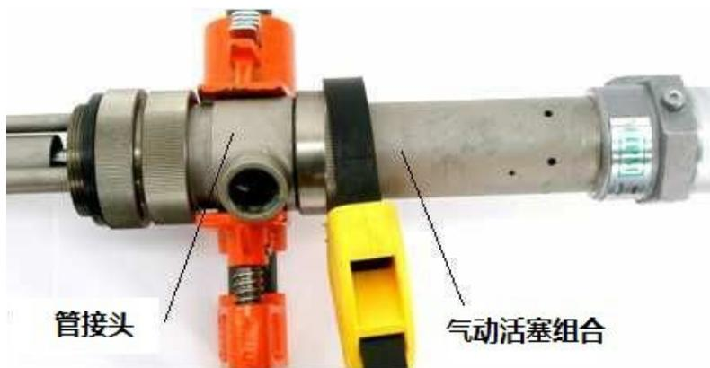
使用皮带扳手将气动马达组件拆下。
