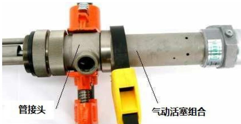
如上图所示，将气动马达部分连接到管接头上。
