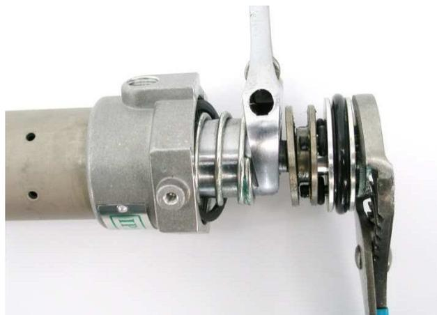
将一把大力自锁钳子放在上阀片滚花区域上，并将板扳手放在平面上以卸下空气活塞组件。检查气缸盖中的弹簧，以确保其没有损坏或松动。检查气缸盖中的垫圈，并根据需要进行更换。该垫圈将气缸盖密封到气缸筒上。还要检查下部复位圆柱弹簧，以确保将其正确固定到气动马达的气缸座组件中。
