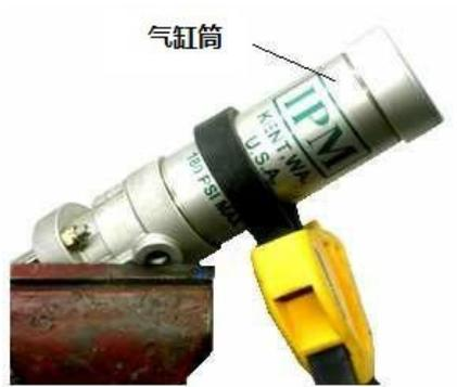
用手或用皮带扳手拆下气缸筒。
